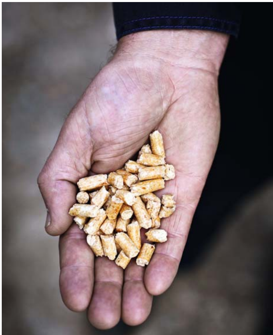
Pelletsen förbränns i hög temperatur med hög verkningsgrad och små utsläpp.
