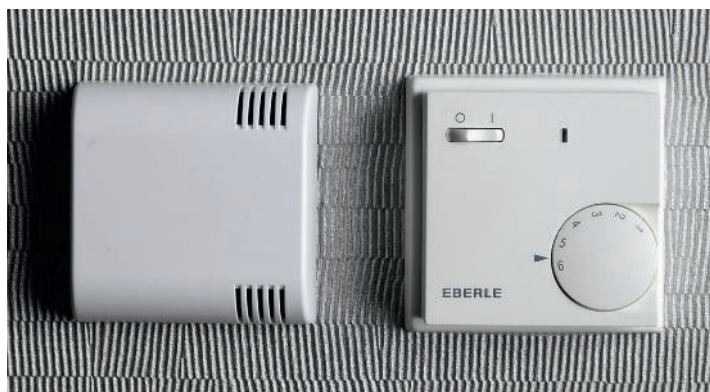
Termostaatti ja anturirasia ovat työpari. Anturi kertoo termostaatille huone-tilan lämpötilan ja termostaatti säätelee lämmitystehoa tarpeen mukaan.
