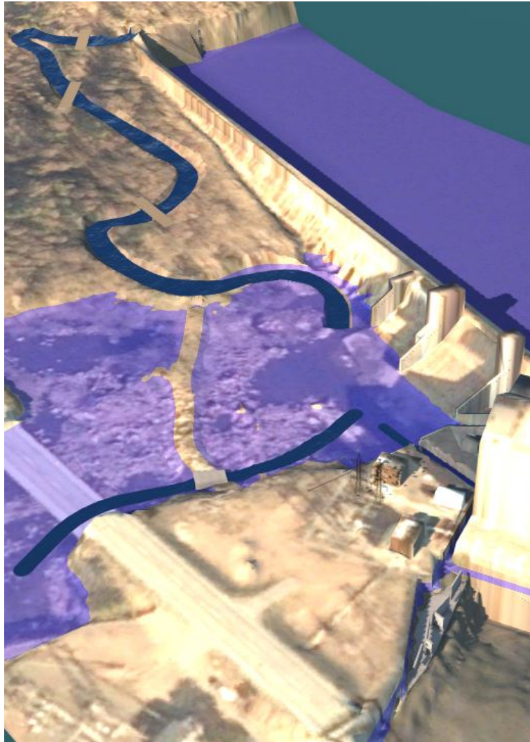
Kuva 14. Hahmotelma Ahvenkosken voimalaitoksen länsipuolelle sijoittuvasta luonnonmukaisesta kalatievaihtoehdosta
