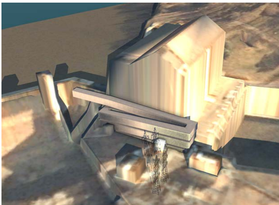
Kuva 7. Hahmotelma Ahvenkoskelle alustavasti tarkastellusta teknisestä kalatievaihtoehdosta
