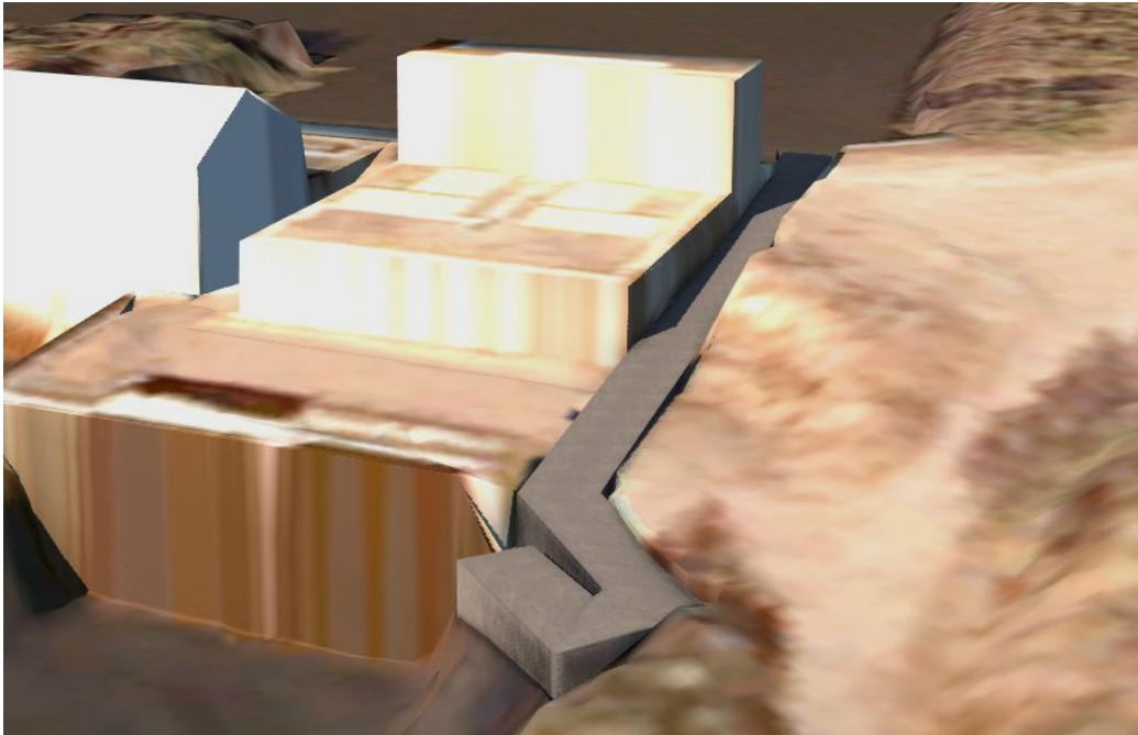
Kuva 20. Hahmotelma voimalaitoksen itäpuolelta kulkevasta pystyrakokalatiestä
