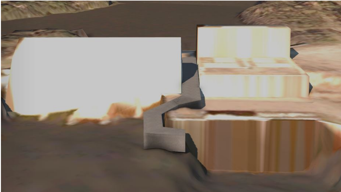
Kuva 18. Hahmotelma laitosten välistä kulkevasta kalatiestä
